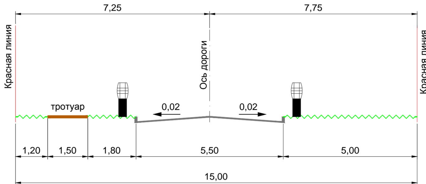
Поперечный профиль одностороннего проезда
